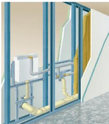
Le pareti interne agli alloggi sono realizzate con struttura metallica e rivestimento sulle due facce in doppia lastra di gesso rivestito con intercluso materiale con funzione di isolamento termico ed acustico. Le pareti attrezzate di bagni e cucine, interessate dalla posa di tubazioni e sanitari, potranno essere, dove necessario, opportunamente rinforzate e avranno caratteristiche di resistenza all'umidità adeguate alla specifica destinazione d'uso.
