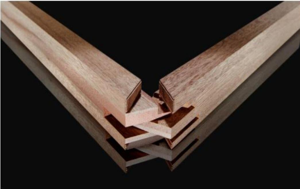
La **giunzione angolare**, creata da noi per infissi in legno (e infissi in legno-alluminio) ha all'interno elementi di 90 gradi che creano una superficie di incollatura doppia, e all'esterno le minizinche a 45 gradi, disegnate a perfetto incastro. Una volta assemblato i profili, il telaio e l'anta godono della **massima stabilità** per una maggiore superficie di contatto e dopo essere stati levigati e verniciati la giunzione angolare non presenta alcuna fuga.
