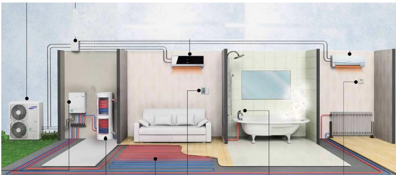
Per la produzione del fluido caldo necessario al funzionamento dell'impianto radiante verrà installata una pompa di calore compatta tipo SAMSUNG Eco Heating System o similare con funzione di produzione di acqua calda sanitaria. L'unità esterna della pompa di calore sarà posizionata a scelta della D.L., così come l'unità idronica, il bollitore e l'impiantistica a corredo.
