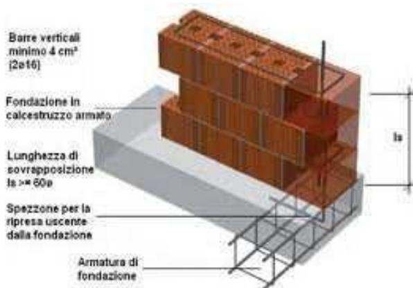
Tutte le murature portanti saranno eseguite in blocchi di termo laterizio alveolato, dello spessore adeguato posato con malta di calce idraulica dosata a q.li 3,50.
