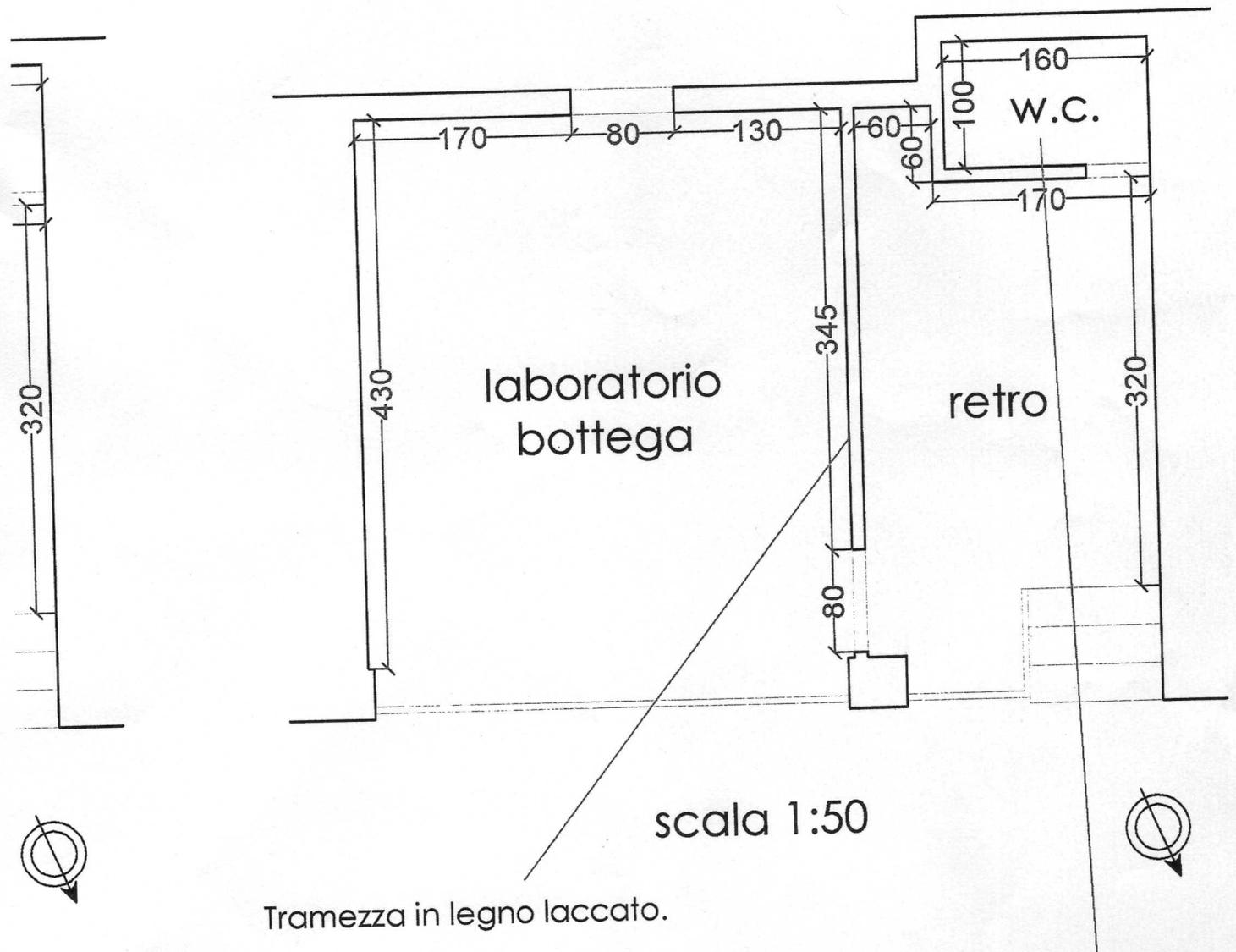
Il w.c. installato sarà della tipologia "Sanitrit" e all'interno del locale verrà installato un impianto di aerazione forzata. Le pareti del locale verranno eseguite in cartongesso.
