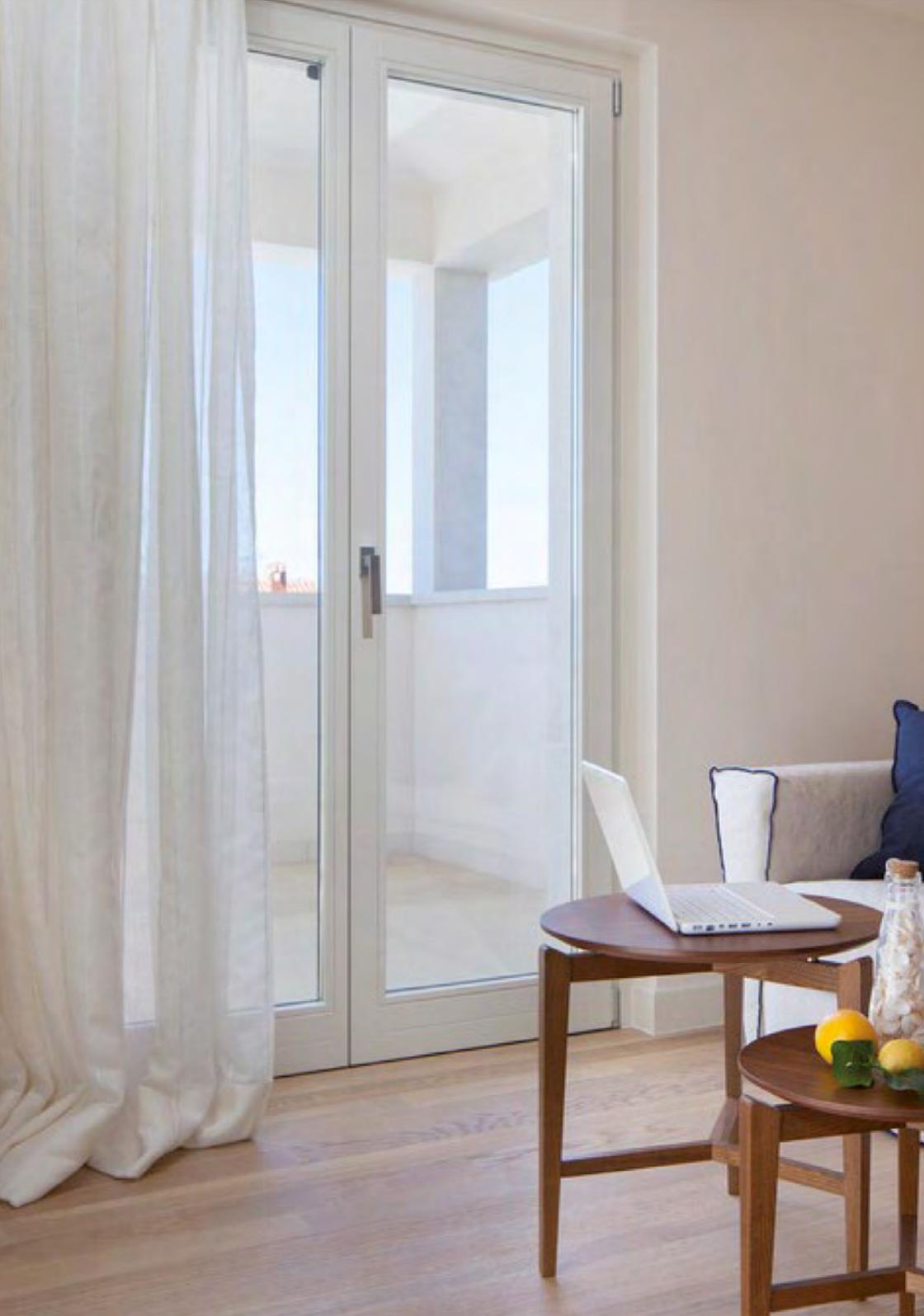
Serramenti con profili in legno lamellare costituito da almeno 3 tavole di legno in essenza di Abete, incollate con collante CLASSE D4 secondo norma EN 204. Profilo di tenuta a tripla battuta con doppia guarnizione e fermavetro sagomato di diverse forme. Serramento con vetro camera in dotazione del tipo basso emissivo più gas argon.
