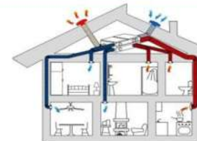
RICAMBIO ARIA MECCANIZZATO E CONTROLLATO VMC
