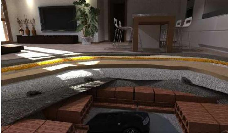
Il piano terra normalmente nasconde due nemici per chi ci abita, il freddo e l'umidità. Le nostre case, grazie ad un'attenta progettazione e messa in opera, sono realizzate tramite un vespaio che separa completamente l'abitazione dal terreno sottostante in maniera continua
