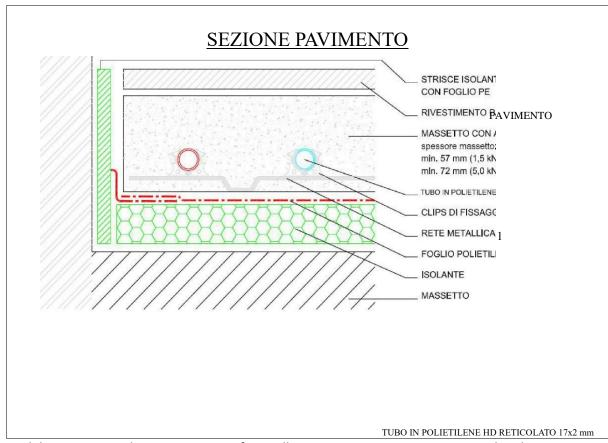
I circuiti del pavimento radiante saranno conformi alla norma UNI EN 1264 e composti da tubazione in polietilene multistrato PE-X avente diametro nominale 17 mm, posata su pannello isolante di polistirene dello spessore di cm. 6 e densità non inferiore a 25 kg/mc e fermata al pannello o con clip oppure l'alloggiamento della tubazione potrà avvenire attraverso le bugne in rilievo di altezza 20 mm.
