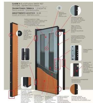
I portoncini di ingresso delle unità immobiliari saranno blindati con grado di sicurezza classe 3, prodotti da primaria ditta e completi di ogni parte necessaria e completati, internamente ed esternamente, con pannelli impiallacciati (lavorazione e colore a scelta della D.L.).
