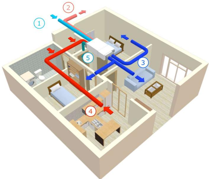
Ciascuna unità immobiliare sarà dotata di impianto di ventilazione meccanica a doppio flusso con recuperatore di calore. Per consentire l'installazione verranno controsoffittate le zone necessarie alla distribuzione delle tubazioni di ripresa e mandata.
