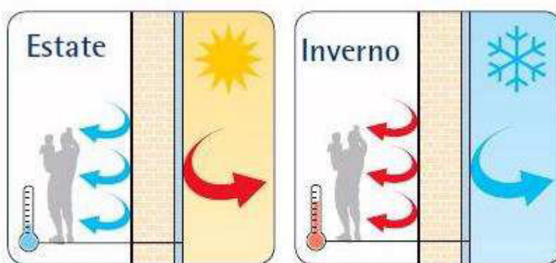
EFFETTI DI UN BUON ISOLAMENTO TERMICO: PIU' CALDO IN INVERNO, PIU' FRESCO IN ESTATE
