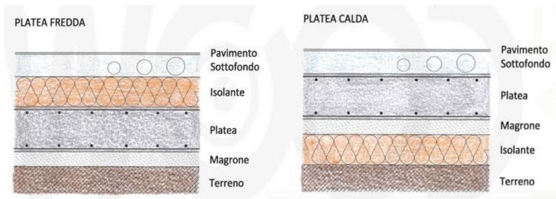
Il vantaggio principale di questo sistema è quello di avere una grossa massa che viene scaldata o raffrescata insieme a tutto l'edificio. Ciò implica un aumento di inerzia termica e un conseguente miglioramento del comportamento termico di tutto il fabbricato, che risulta meno soggetto a fluttuazioni di temperatura interna. È di conseguenza più semplice mantenere una temperatura costante all'interno dell'edificio, fattore molto importante nel caso di costruzioni passive.
