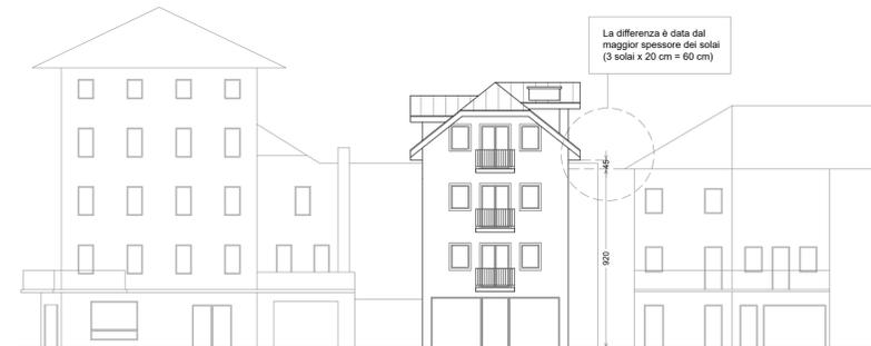
PROSPETTO EDIFICI LIMITROFI PROGETTO Scala 1:200
