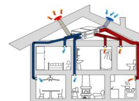
RICAMBIO ARIA MECCANIZZATO E CONTROLLATO VMC
