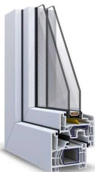
Gli infissi esterni saranno in pvc bianco an un'anta o a due, dotate di telaio STD, prof. 76 mm altezza 68 mm, 5 camere dotate di guarnizione di tenuta, fermavetro ed anta-ribalta, completi di vetri 33.1/15Ar/33.1 th (Ug=1.1) 28 mm.
