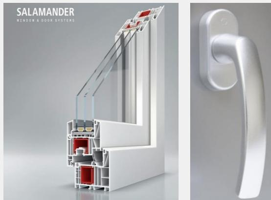
Le finestre **BluEvolution 82** offrono una soluzione solida e affidabile per chi cerca prestazioni di alta qualità. Il telaio multicamera e le tre guarnizioni di tenuta assicurano un eccellente isolamento termico. I profili, realizzati secondo standard elevati e rinforzati con acciaio zincato nelle ante e nei telai, garantiscono resistenza a sollecitazioni meccaniche e sbalzi termici.
