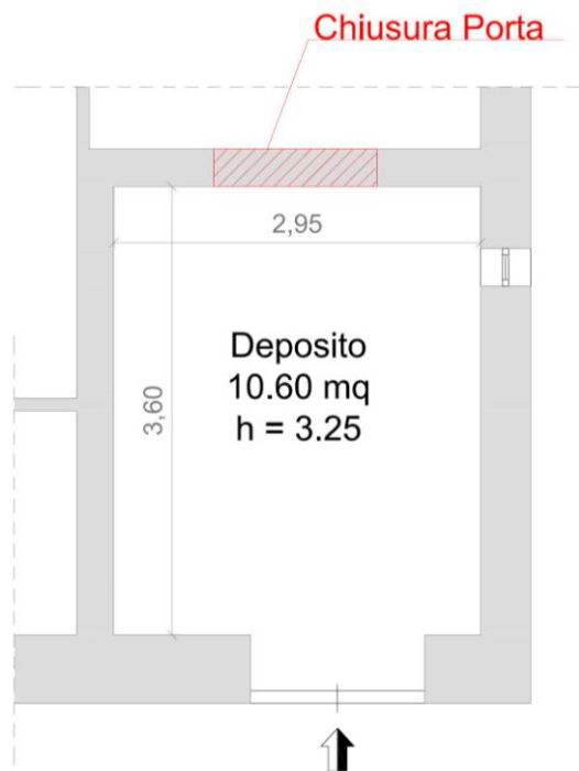
Figura 27 - Planimetria Stato di fatto Foglio 46, p.lla 1235, sub 21.
