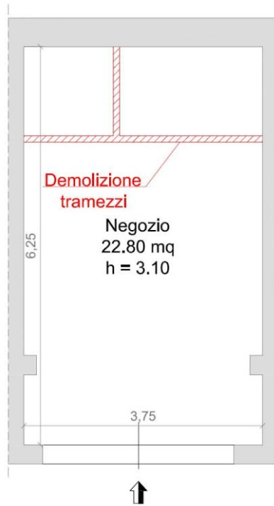
Figura 31 - Planimetria Stato di fatto Foglio 29, p.lla 748, sub 10.
