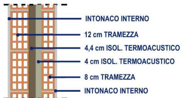
3. Realizzazione di **tramezze di divisione interne**, mediante la posa di blocchi in **laterizio forato, dello spessore di 8 cm.**, lavorati con malta bastarda, compreso gli occorrenti ponteggi interni e gli architravi delle porte interne.
