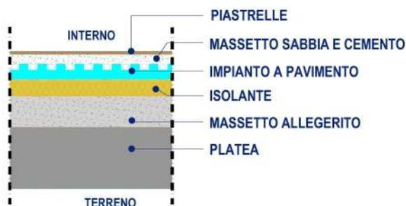
15. Realizzazione di **isolamento sul solaio con sottostante zona garage/portico interno/vano scala** (locale non riscaldato) mediante la posa di un pannello in polistirene espanso o similare dello spessore di 4 cm. tra il massetto alleggerito ed il massetto di sottofondo in sabbia e cemento dove a sua volta verrà incollata la pavimentazione.
