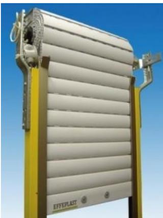
L'oscuramento sarà ottenuto mediante oscuranti avvolgibili in PVC con profili estrusi pesante, rispondente alle norme UNI, compresa puleggia, rullo scanalato di acciaio, con cuscinetti a sfera, il sistema di apertura e chiusura sarà del tipo elettrico completi di cassette EPS per alloggiamento degli oscuranti e completi di spalla coibentata ad ispezione frontale ed inferiore a taglio termico.
