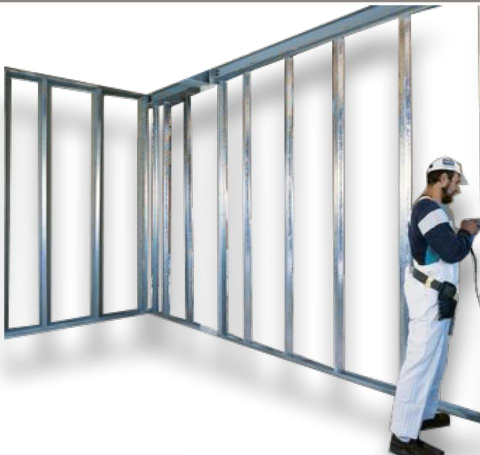
Le pareti interne degli appartamenti saranno realizzate con sistema Knauf, composto da orditura metallica auto portante e rivestimento con doppia lastra di gesso rivestito per lato, con interposto strato di isolante termoacustico in lana minerale, spessore parete finita 125 mm. I divisori tra gli appartamenti saranno realizzati con blocco in laterizio per murature divisorie APF ad alte prestazioni fonoisolanti e
