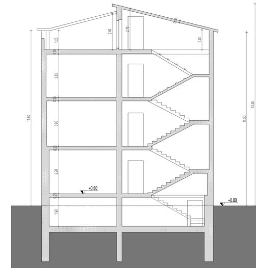
SEZIONE A-A PROGETTO scala 1:100
