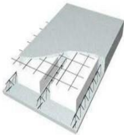
TIPO SOLAIO PIANO INTERRATO
