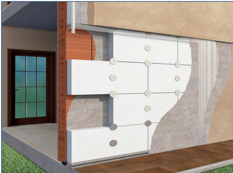
Le murature esterne di tamponamento saranno in laterizio portante dello spessore di cm. 25, rivestite con isolamento esterno costituito da Lastre tagliate REXPOL realizzate in Polistirene ECO 36 TR100 dello spessore minimo di cm. 14.
