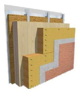
Tutte le pareti portanti saranno realizzate in X-LAM a 5 strati dello spessore compreso tra i 100 e i 140 mm. Esternamente saranno rivestite con isolamento a cappotto in fibra di legno dello spessore di 160 mm. rasate e intonacate con intonaco naturale in calce dello spessore di 10-13 mm.
