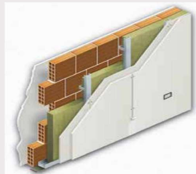
Figura 14 – Parete divisoria tra unità abitative
