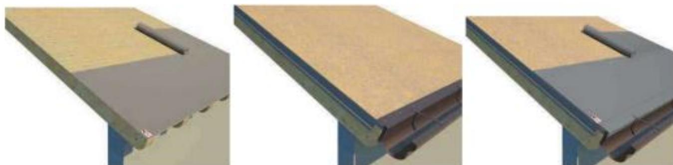
La parte soprastante, la copertura in CLS, sarà realizzata previa collocazione del tessuto freno-vapore, pannello in materiale isolante (lana di roccia), listelli in abete per l'areazione della copertura, pannello di compensato OSB, ondulina bituminosa sottocoppo e successivo manto di copertura realizzato con coppi siciliani, completi di pezzi speciali. Le gronde saranno realizzate in lamiera.
