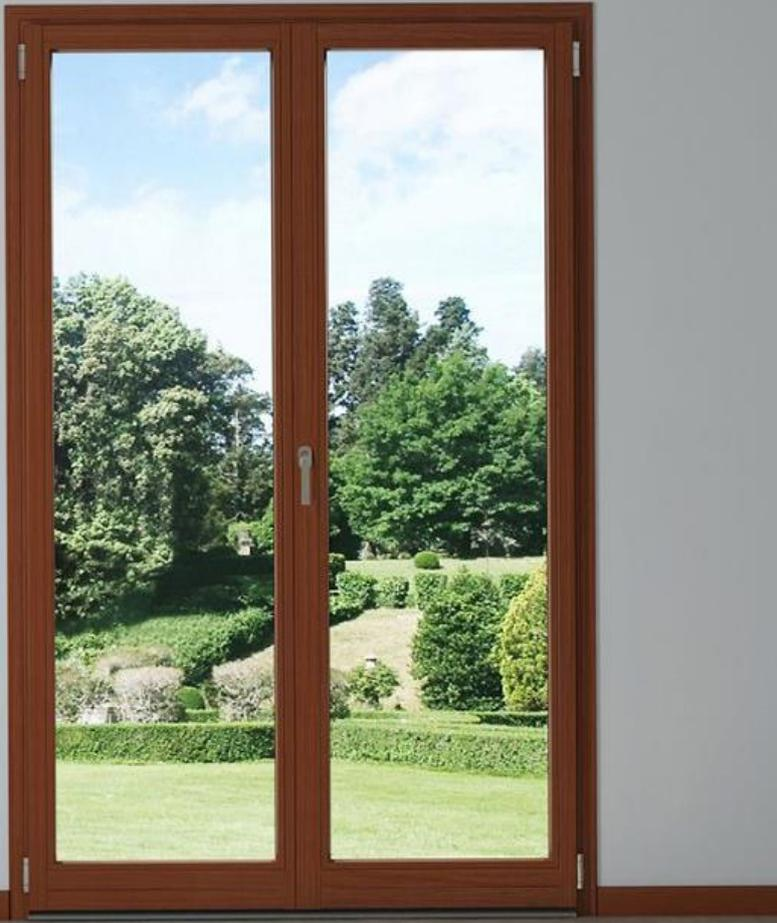
I serramenti esterni, finestre e portefinestre, sono in pino lamellare tinto noce, di tipo monoblocco con sezione da mm. 68 x 75, completi di ogni accessorio di funzionamento e vetri di tipo basso-emissivo efficienti a contrastare lo scambio per irraggiamento.
