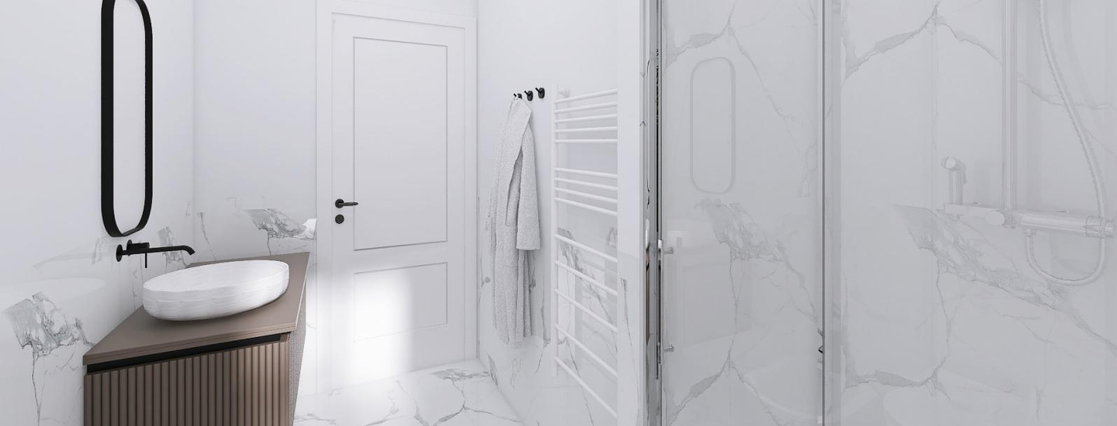
Nei bagni, sulle superfici orizzontali e verticali, il rivestimento sarà realizzato con lastre in gres porcellanato fino ad h 200 cm, colore grigio chiaro, formato 60x120 cm, posate con idonei collanti e con caratteristiche antiscivolo conformi alle norme vigenti.
