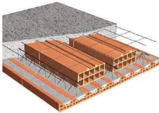
I solai di calpestio e copertura dei piani superiori saranno realizzati con struttura mista tradizionale in travetti e pignatte, spessore 20x5 cm, comprenderanno la casseratura completa dell'impalcato di posa e la relativa puntellatura, la fornitura e getto con pompa del calcestruzzo per l'intasamento degli elementi e per la formazione della cappa superiore da 5 cm, la fornitura e posa della rete elettrosaldata e dell'acciaio di monconatura, il disarmo finale.
