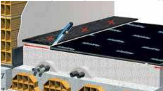
dello spessore di circa cm. 5-6; su detto strato viene posato un telo Isolmant biplus spessore mm. 9 per isolamento acustico anti calpestio, sulle pareti perimetrali e sui tramezzi interni viene fissata una fascia perimetrale di desolidarizzazione reticolata
