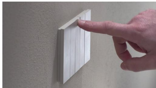
Sarà quindi possibile comandare ogni singolo punto luce da singoli comandi o da un unico comando creando scenari luminosi, che consente l'accensione di gruppi di luci opportunamente abbinati. Anche la chiusura e l'apertura delle tapparelle avrà la possibilità di avere un comando di funzionamento per ogni singola tapparella e un comando unico per un contemporaneo funzionamento di tutte le tapparelle o settori di aree.
