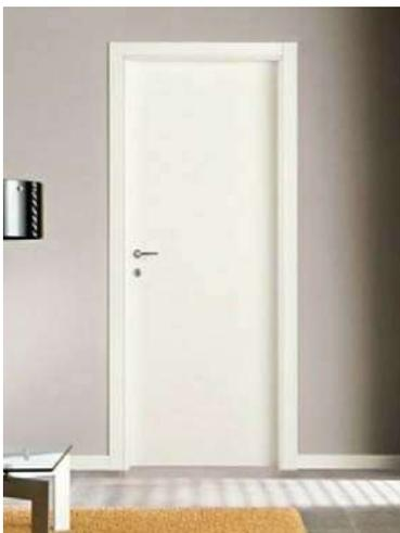
**Serramenti interni bianchi (porte)**, porte lisce con casse rette; anta costituita da un telaio in listellare e coprifili in multistrato, serratura magnetica, cerniere a scomparsa, maniglia quadra e accessori cromo satinati con guarnizioni perimetrali di battuta bianche.
