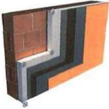
**Isolamento a cappotto** dello spessore di cm 14 sulle pareti verso l'esterno eseguito mediante applicazione di lastre in Polistirolo espanso ECO o similari, il tutto comunque come previsto da L.10, completo di relativa rasatura armata; il risvolto nell'intradosso dei solai delle terrazze e nei muretti dei poggioli in cappotto mediante applicazione di lastre in polistirolo espanso EPS 100, dello spessore di cm 5/6, avendo funzione di taglio termico.
