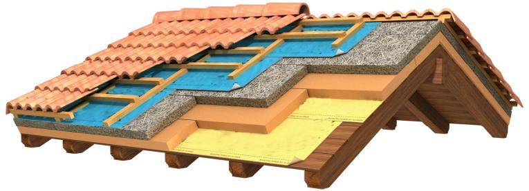
Le caratteristiche di questo tetto ventilato abbinano un ottimo isolamento termico ad un elevato abbattimento acustico. Eventualmente, a discrezione della D.L. verrà posato un pacchetto di chiusura con le medesime caratteristiche prestazionali.
