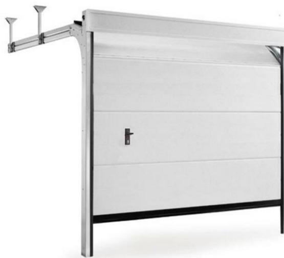
Completa di guide di scorrimento verticali ed orizzontali in acciaio zincato, albero portamolle con molle di torsione, paracadute contro rottura molle, cerniere interne in acciaio zincato e/o verniciato bianco, rulli di scorrimento in guida, guarnizioni di battuta ed imballo.
