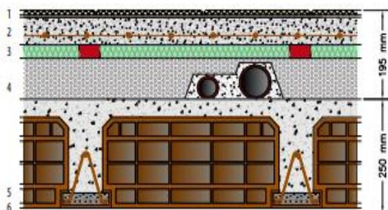
1. Pavimentazione di finitura in ceramica incollata, sp. 15 mm
