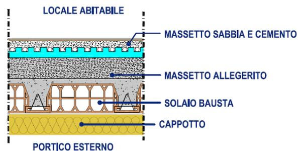
15. Realizzazione di **isolamento sul solaio con sottostante zona garage** (locale non riscaldato) mediante la posa di cappotto un pannello in polistirene espanso, lana di roccia o similare dello spessore di 8 cm. (cappotto)
