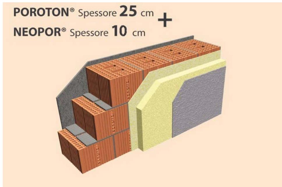
**Isolamenti Termici:** Gli isolamenti impiegati nelle nostre costruzioni sono di ottima qualità. La posa degli isolanti è molto importante per ottenere dei grandi risultati, nelle nostre costruzioni già in fase di progettazione vengono studiati i sistemi migliori per eliminare i ponti termici
