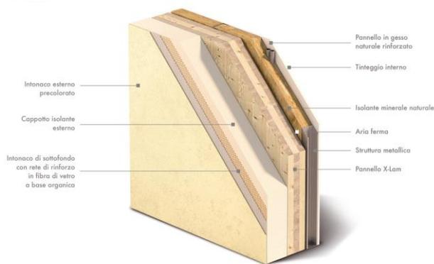
L'X-Lam, o Cross Laminated Timber (CLT), è un materiale costruttivo di nuova generazione composto da tavole in legno massiccio disposte a strati incrociati, incollate insieme sotto grandi pressioni per formare un unico elemento massiccio piano, con capacità portante in entrambe le direzioni. L'X-Lam può essere definito a
