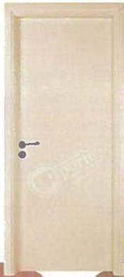
Le porte interne saranno della marca GP PORTE serie CLASSIC, costituite da una struttura tamburata rivestita in laminatino di varie colorazioni, cieca liscia completa di telaio squadrato e coprifili ad incastro. Testa, montanti piatti, cerniere e maniglia, con guarnizione antirumore, ferramenta e serratura magnetica, o similari. Le cerniere e la bocchetta saranno in color cromo satinato.
