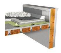
Il solaio verso il piano interrato verrà realizzato con una struttura PB tipo predalles REI 120, con soprastante pannello d' isolamento termico e, dove necessario, materassino anti-calpestio.
