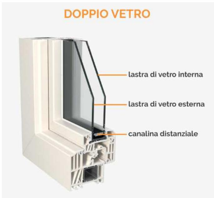
I vetri doppi del tipo multicamera (ndr doppia vetrocamera) con doppio vetro basso emissivo con vetrocamera con gas Argon, del tipo 33.1/16/33.1 fermavetri riportati, e guarnizioni in plastica biflex, compresi coprifili interni; maniglie in alluminio tipo Milena, nei colori ottone e/o acciaio come le cerniere.
