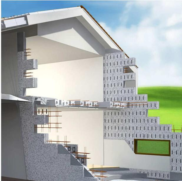
Le strutture verticali dell'edificio dall'estradosso di copertura del piano interrato fino alla copertura del tetto sarà del tipo ICF (Insulated Concrete Forms) per realizzare pareti in c.a. in grado di integrare grazie al cassero ICF le capacità di resistenza meccanica del calcestruzzo con le capacità di isolamento termico del polistirene.
