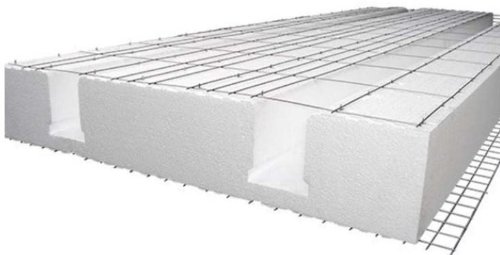
pignatte in EPS con caldana superiore in calcestruzzo, cls alleggerito con annegati impianti, materassino anticalpestio, pannelli radianti per il riscaldamento, sottofondo in cellulare e piastrella. Lo spessore totale del solaio risultante sarà in totale di 550 mm composta da 350 mm di parte strutturale, e 200 mm di pacchetto architettonico comprensivo di 5 cm di isolante xps borchiato, il tutto crea un eccellente isolamento termico e acustico.
