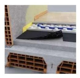
L'isolamento termico dei solai verrà invece realizzato mediante la posa di pannelli termo-isolanti in polistirene ad alta densità di spessori vari a seconda della zona da coibentare.
