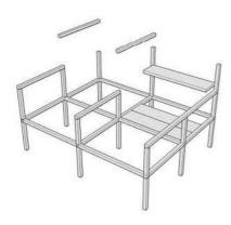
Le strutture portanti saranno in calcestruzzo armato con muri in elevazione, pilastri e travi. Tutti i solai, di altezza conforme ai calcoli statici per i sovraccarichi previsti, saranno del tipo misto gettati in opera.
