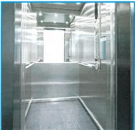
Sarà di tipo a fune con motore posto all'interno del vano corsa e sarà della ditta Kone modello monospace con cabina in acciaio, le porte di accesso di tipo scorrevole con spallette architrave in pietra di luserna o beola.
