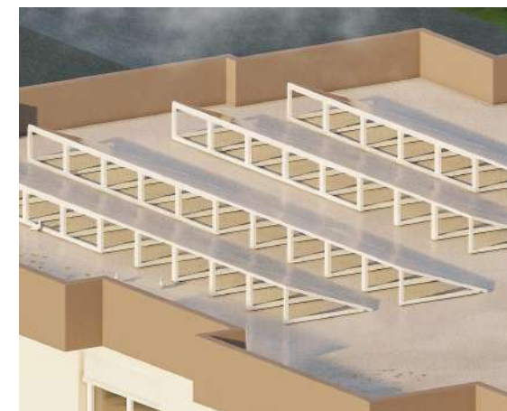
Copertura isolata con botola di accesso, linea vita e pannelli fotovoltaici
