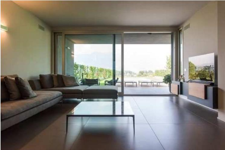
Le ante saranno ad uno o più battenti apribile o scorrevole (ove previsto) e saranno dotate di vetrate termoisolanti a basso emissivo secondo normativa di riferimento, le finestre o portefinestre dei bagni saranno altresì dotate di sistema di apertura a vasistas e di maniglia finitura acciaio satinato.
