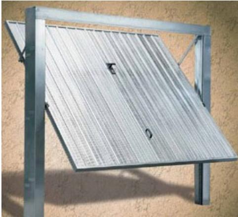
► Le serrande dei box saranno del tipo basculante auto-bilanciate, con contrappesi scorrevoli, in lamiera zincata con fessure di areazione; saranno manuali complete di serratura tipo "Yale", catenaccio e maniglia fissa.
