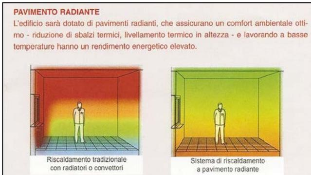
L'emanazione del calore avviene mediante irraggiamento, adeguato e controllato, a temperatura uniforme attraverso tutta la superficie del pavimento, nel quale sono annegate serpentine realizzate con tubi in polietilene su una base di pannelli isolanti.
