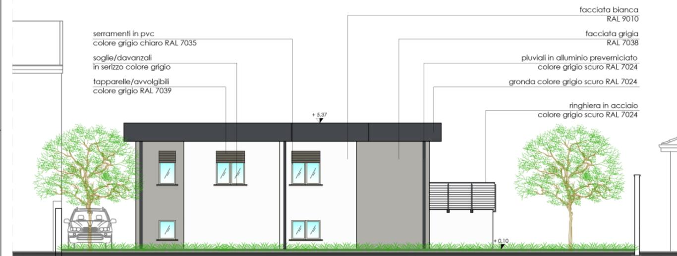
STATO DI PROGETTO: PROSPETTO SUD-OVEST
