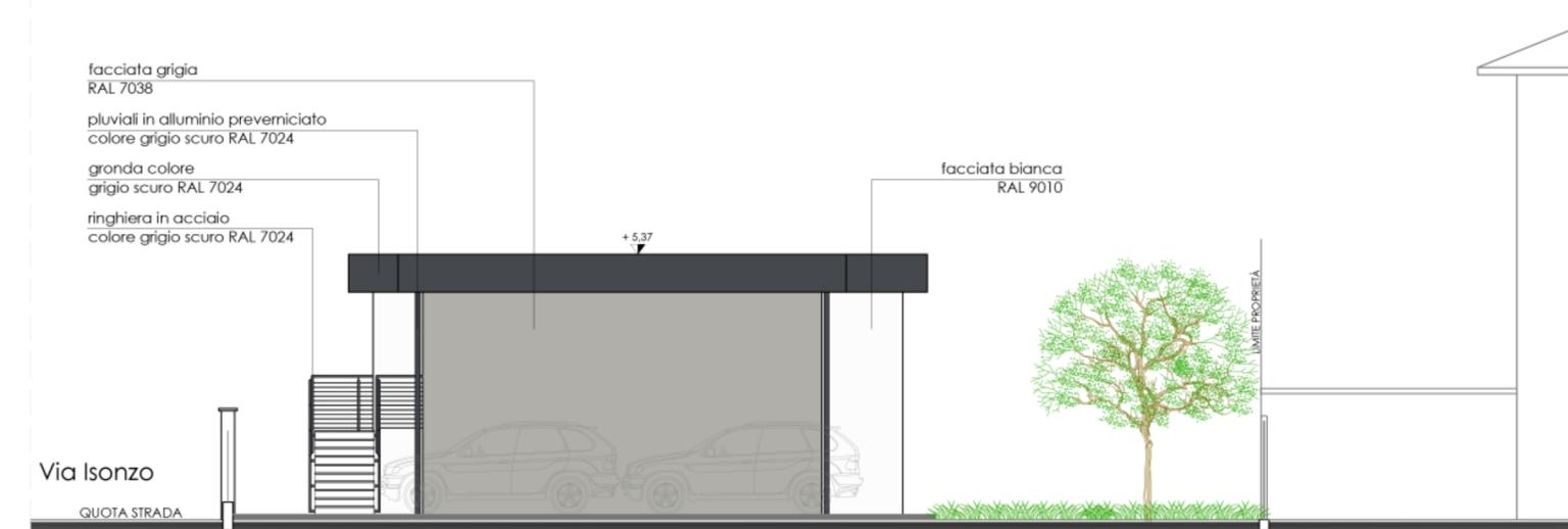
STATO DI PROGETTO: PROSPETTO NORD-EST
