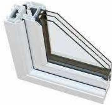
reazione al fuoco. La scelta permette di unire le ottime prestazioni termiche dei profili con ampie superfici vetrate, come previsto dal progetto. I profili avranno colore a scelta delle D.L.. I vetri sono tutti realizzati con vetrata isolante a doppia barriera composta da tre lastre di cristallo separate da un'intercapedine di aria secca. Le vetrate isolanti sono marchiate UNI e Climalit al fine di avere la garanzia decennale contro l'appannamento. Le maniglie saranno cromate satinare.
