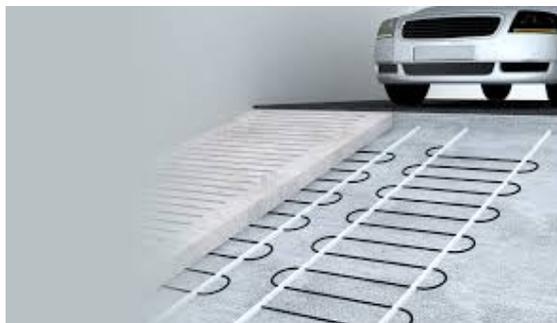
La pavimentazione delle rampa di discesa al piano interrato sarà di colore grigio, con riquadrature antisdrucchiolevoli a spina di pesce e con sottostante serpentina elettrica antineve ed antighiaccio azionata da sensori esterni.
